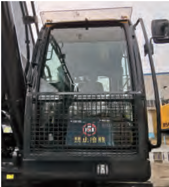
Tela de proteção inferior do para-brisa
