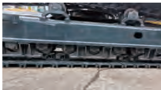
3x guias de esteira para melhor deslocamento
