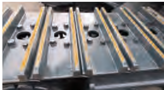
Sapatos de garra dupla para maior tração e estabilidade na operação
