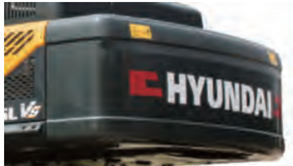
Contrapeso maior para proporcionar maior estabilidade na operação
